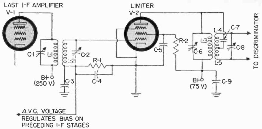
Fig. 5 A simple limiter circuit.
