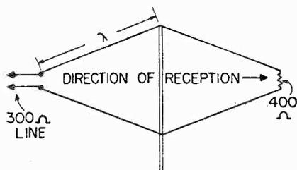
**Fig. 11** The V antenna.
