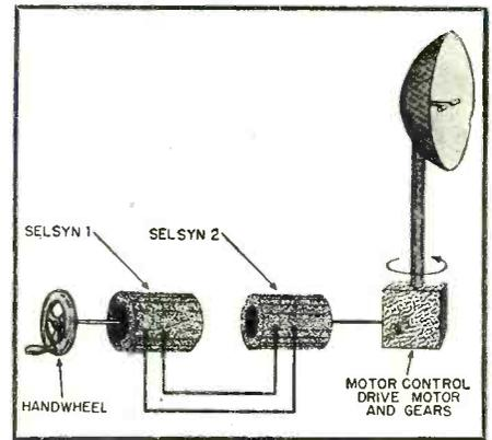
Fig. 14. A selsyn motor system.
