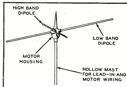
Fig. 17. Motor-driven antenna.
