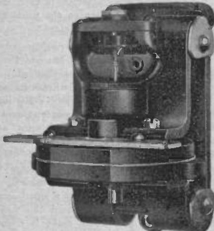
Fig. 4. Meter Ready for Magnets
