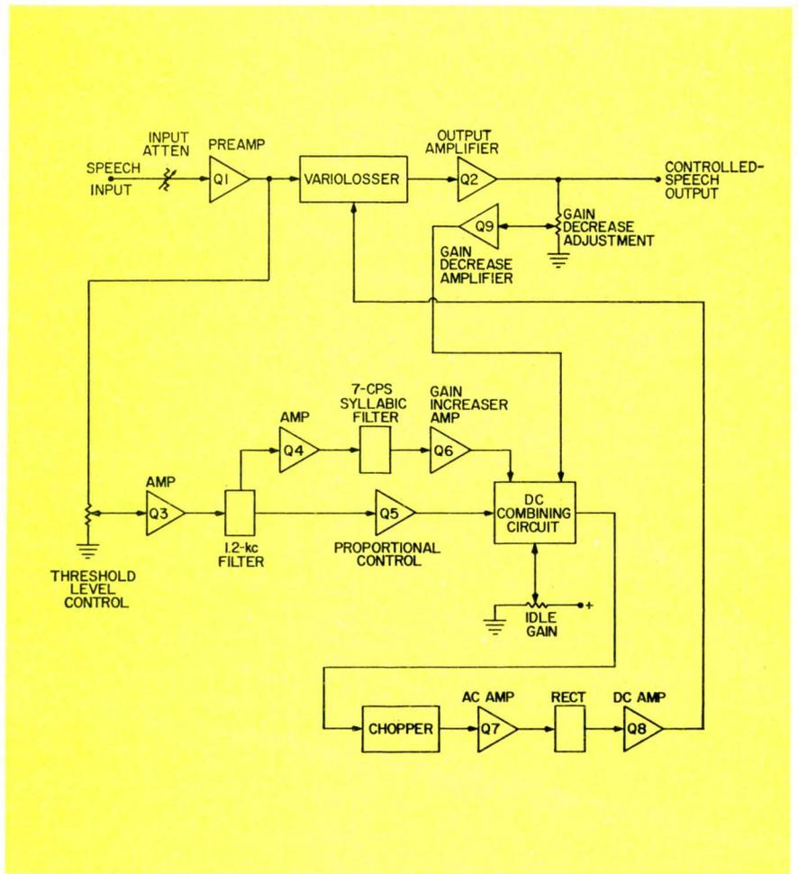
Fig. 1—Block diagram of AGAMP.
