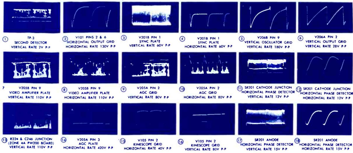
**KCS175 CHASSIS VOLTAGE WAVEFORMS**
