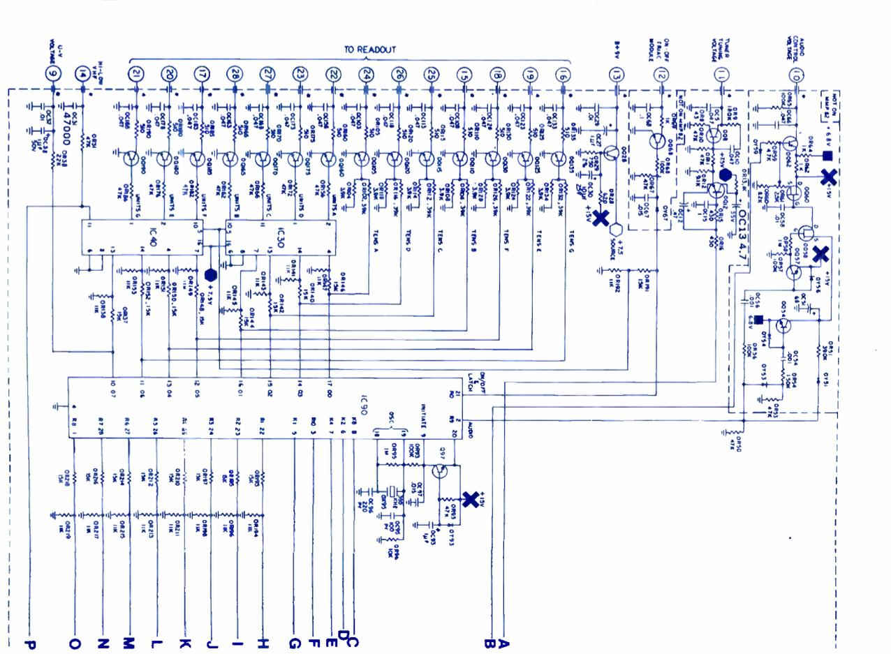
SCHEMATIC DIAGRAM TUNER CONTROL MODULE
