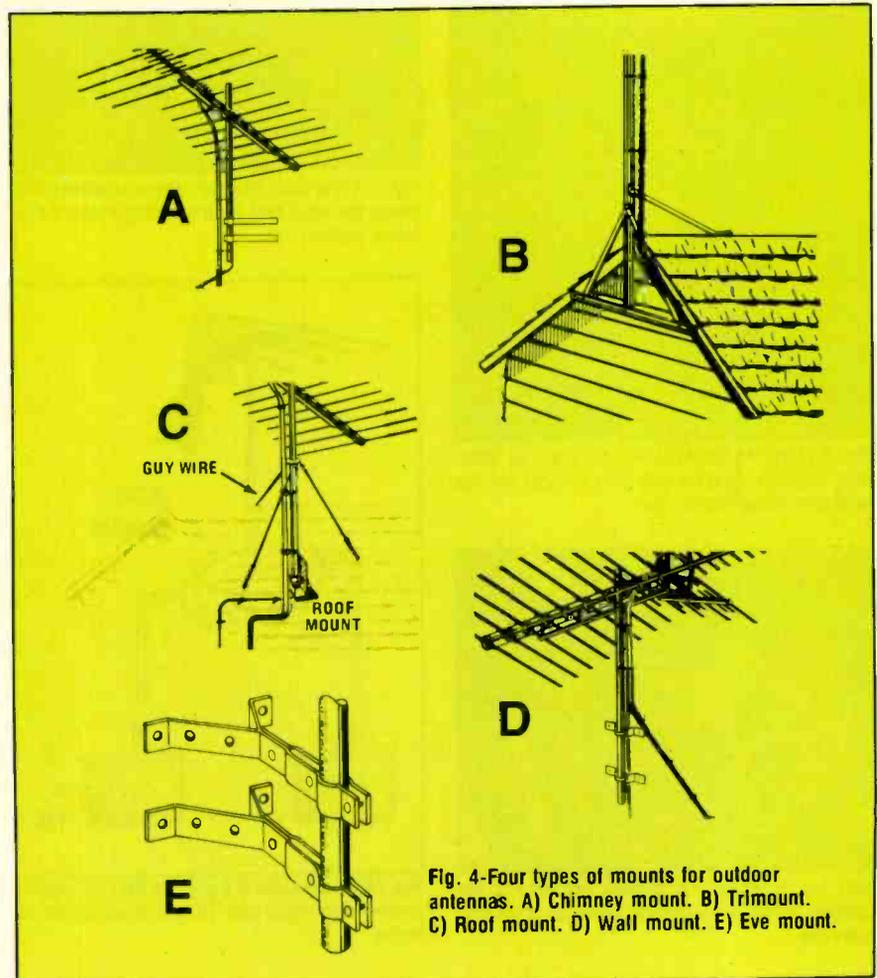
Fig. 4—Four types of mounts for outdoor antennas. A) Chimney mount. B) Trimount. C) Roof mount. D) Wall mount. E) Eave mount.
