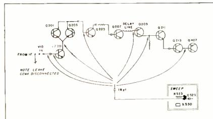
*Fig. 6. Signal module (video).*
