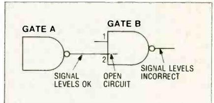
Fig. 8. An open input pin.
