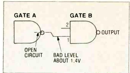
Fig. 7. An open output pin.
