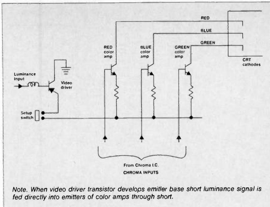
Fig. 3. Zenith 9-89 video output module
