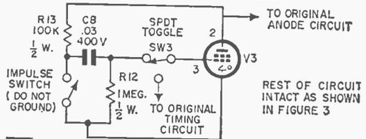
10 AUXILIARY TRIGGER CIRCUIT
