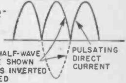
**C** FULL-WAVE RECTIFIER WAVEFORM
