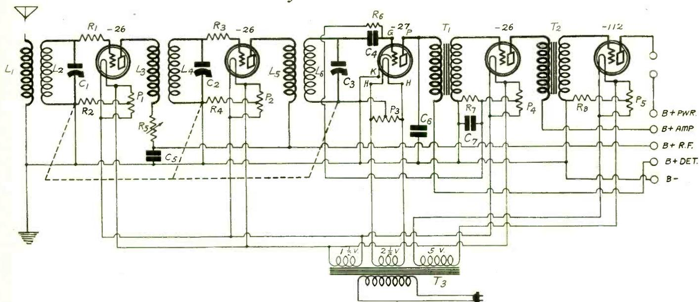
IN AN AC OPERATED RECEIVER A POSITIVE GRID BIAS CAN BE GIVEN TO THE GRID OF THE -27 TYPE DETECTOR BY CONNECTING THE CATHODE TO THE NEGATIVE SIDE OF THE POWER SUPPLY AND THEN CONNECTING THE GRID LEAK RETURN TO THE HIGH VOLTAGE END OF ONE OF THE GRID BIAS RESISTORS. (R7 ABOVE.) THE POSITIVE BIAS ON THE DETECTOR THEN HAS THE SAME VALUE AS THE NEGATIVE BIAS ON THE FIRST AUDIO AMPLIFIER.
