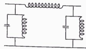
Fig. 5. Band Pass Filter
