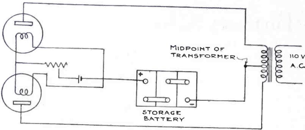
Fig. 6. Full Wave Rectification
