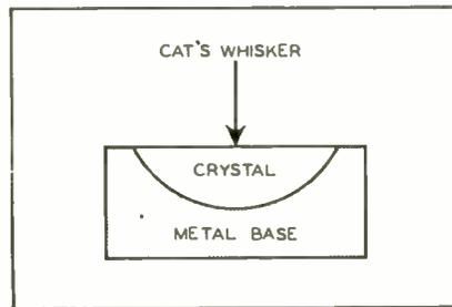
Fig. 1. Components of simple crystal rectifier
