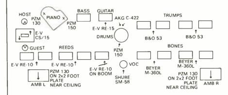
Figure 9: TYPICAL BIG BAND SETUP FOR LIVE REMOTE
