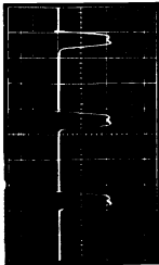
AGC Pulse 22Vp-p 15.75KHz
