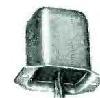
**HORIZONTAL BLOCKING-OSCILLATOR TRANSFORMER**
