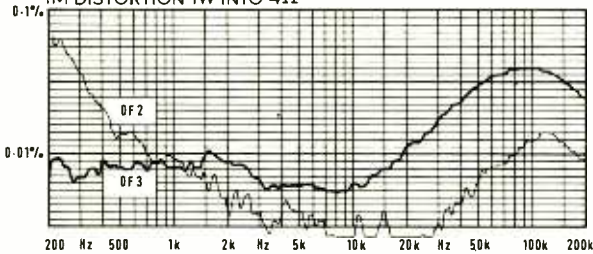
FIG. 6 TOA P300D IM DISTORTION 450W INTO 4 \Omega
