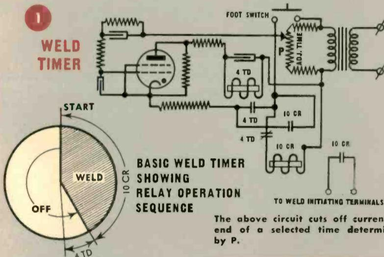
BASIC WELD TIMER SHOWING RELAY OPERATION SEQUENCE
