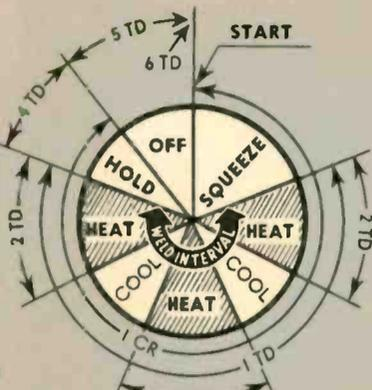
AUTOMATIC REPEAT PULSATION WELDING (NON-SYNCHRONOUS) SHOWING RELAY OPERATION SEQUENCE
