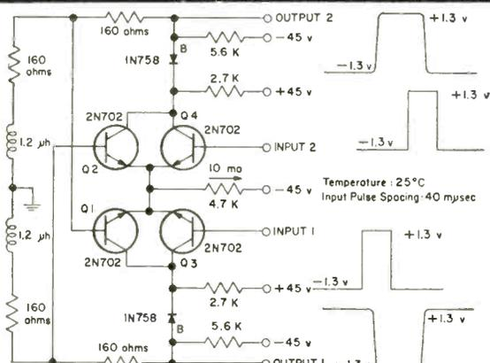
TYPICAL CIRCUITRY FOR OBTAINING 25-MC REP RATE
