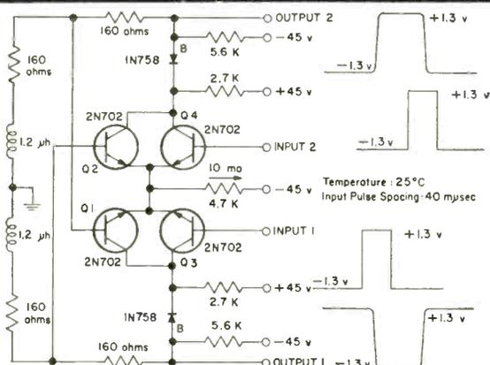
TYPICAL CIRCUITRY FOR OBTAINING 25-MC REP RATE
