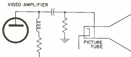
Fig. 9: A peak rectifier DC restorer ckt.
