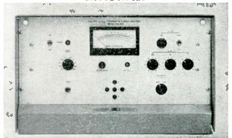
PULSED I<sub>B</sub> (h<sub>FE</sub>) TRANSISTOR TESTER
