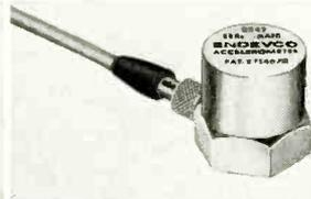
**HIGH TEMPERATURE ACCELEROMETER**
