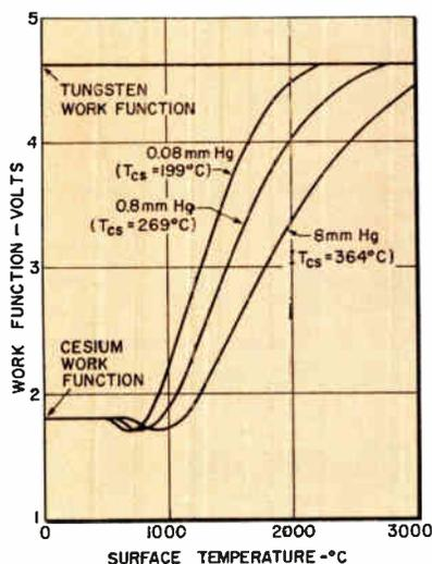
Fig. 10: Work function of tungsten in cesium vapor.
