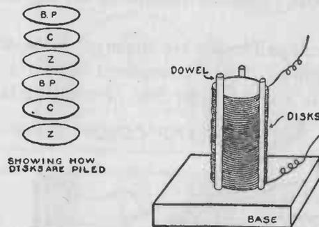
FIG. 217. — A simple Voltaic pile.
