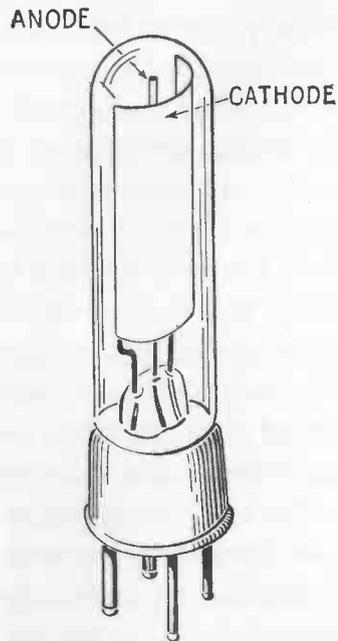
AN ALKALINE PHOTO-ELECTRIC CELL OR ELECTRIC EYE
