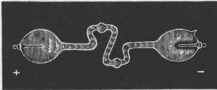
ELECTRICAL DISCHARGE IN A GEISSLER TUBE
