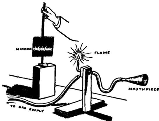
FIG. 129.—Koenig's manometric flame apparatus.
