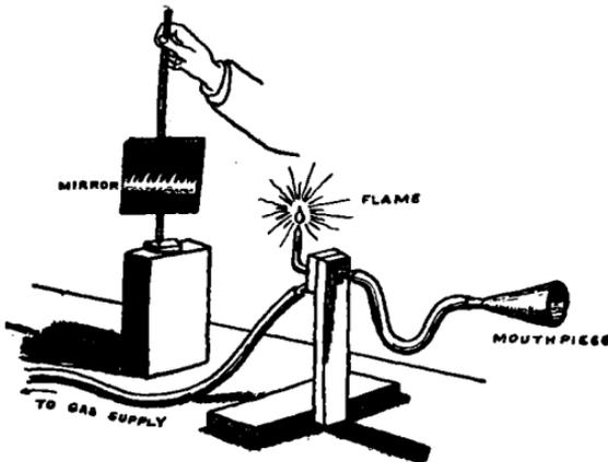
FIG. 129.—Koenig's manometric flame apparatus.
