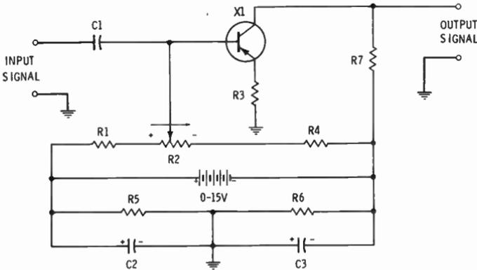
Fig. 41. A transistor triode limiter.
