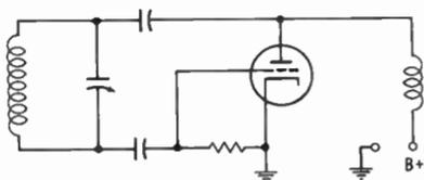
Fig. 20. Ultra-audion oscillator circuit.
