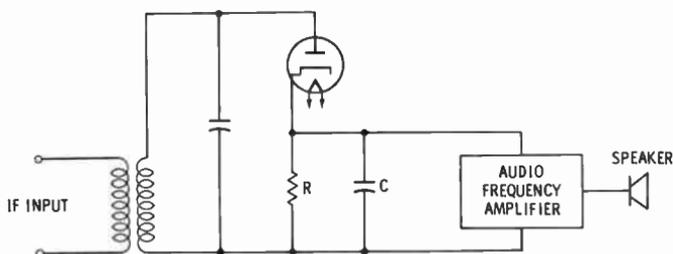
Fig. 18. A diode-detector circuit.
