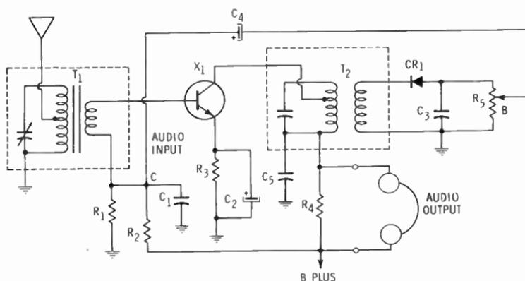
Fig. 29. A transistor reflex circuit.
