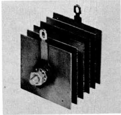
Fig. 3. A selenium rectifier.
