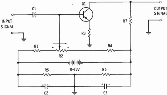
Fig. 41. A transistor triode limiter.
