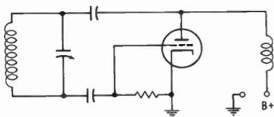
Fig. 20. Ultra-audion oscillator circuit.
