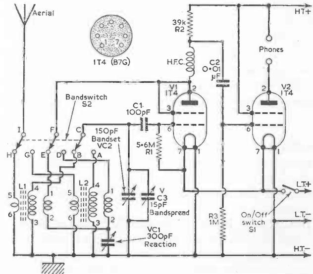
Fig. 19. The circuit.
