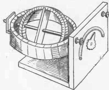
Fig. 177.—Variometer Complete
