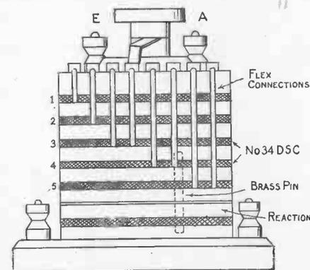
Fig. 124.—The Complete Tuner
