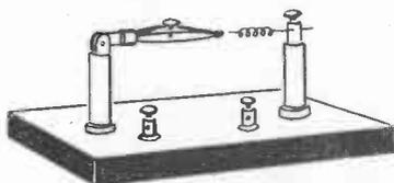
Fig. 30.—"Drawing-pen" Detector
