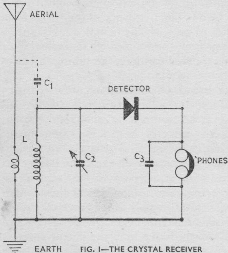
FIG. 1—THE CRYSTAL RECEIVER
