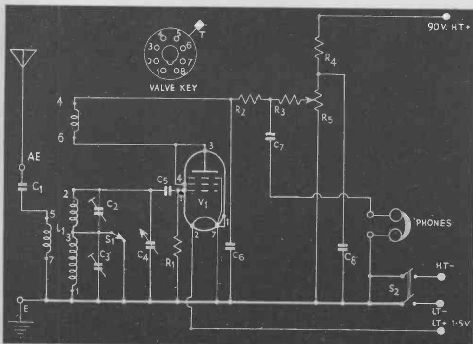
FIG. 6—THE ONE-VALVE RECEIVER
