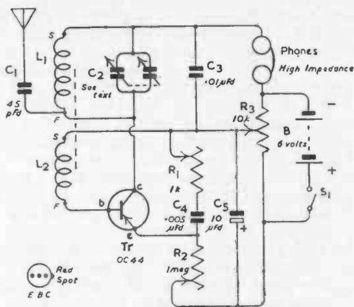
FIG. 10. A SUPERREGENERATIVE RECEIVER
