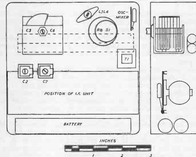
FIG. 9. THE ORIGINAL LAYOUT FOR THE POCKET SUPERHET
