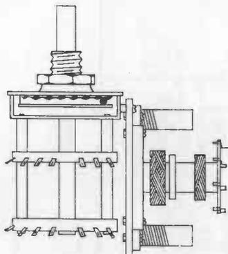
FIG. 16. THE SWITCH ASSEMBLY
