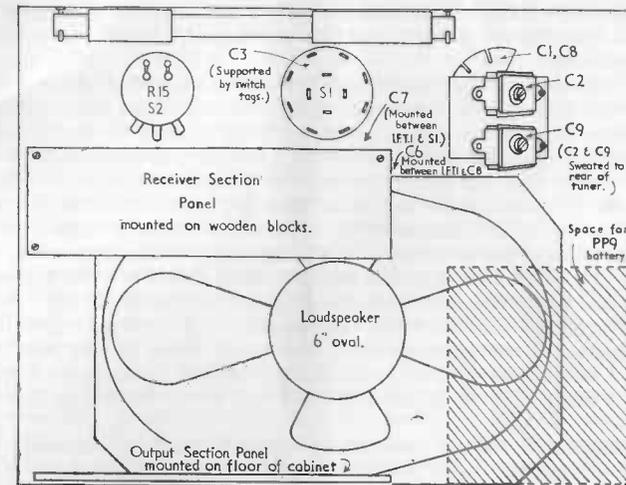
FIG. 13. THE RECEIVER CABINET LAYOUT
