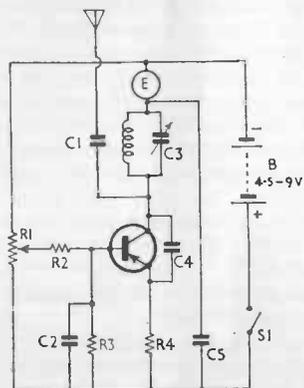
FIG. 14. THE BASIC T.R.F. RECEIVER
