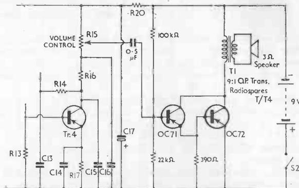
FIG. 10. A SIMPLE LOW POWER OUTPUT STAGE
