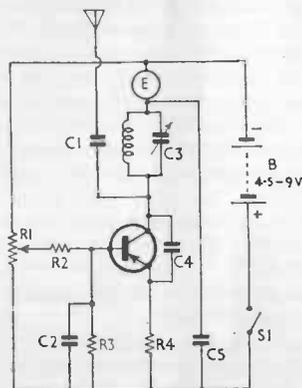
FIG. 14. THE BASIC T.R.F. RECEIVER
