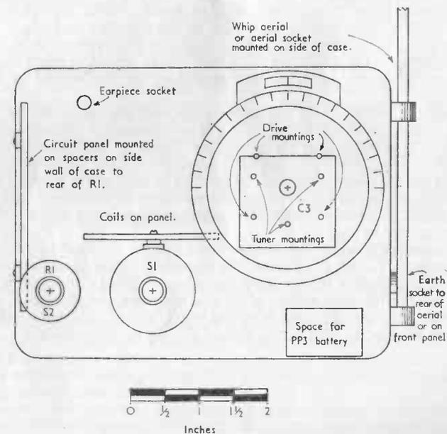
FIG. 20. THE SIMPLE ALL-WAVE RECEIVER CASE LAYOUT
