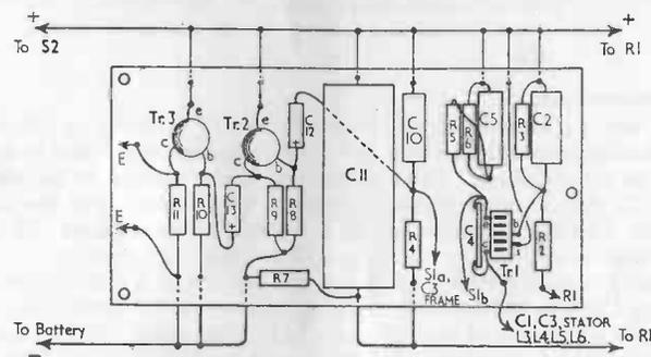
FIG. 18. THE SIMPLE ALL-WAVE RECEIVER CIRCUIT PANEL
