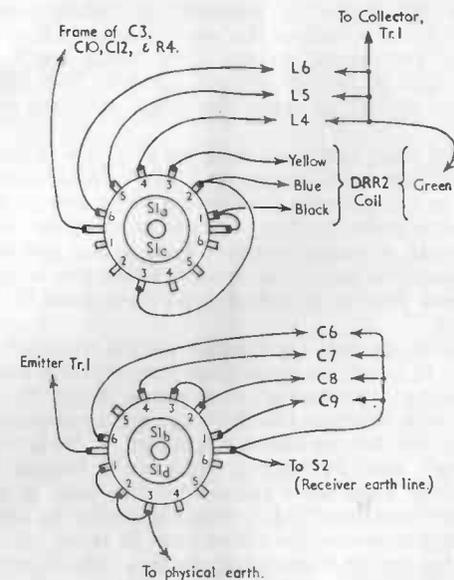
FIG. 19. SWITCH WIRING IN THE SIMPLE ALL-WAVE RECEIVER
