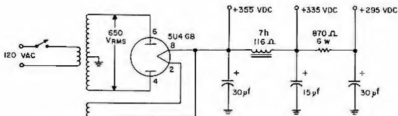
NOTE: PEAK STEADY STATE REVERSE VOLTAGE ACROSS ANODE TO CATHODE OF 5U4GB IS 650VZ-920 VOLTS.
