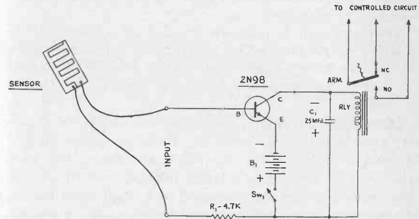
Fig. 10-4.—"Rain Alarm" circuit.
