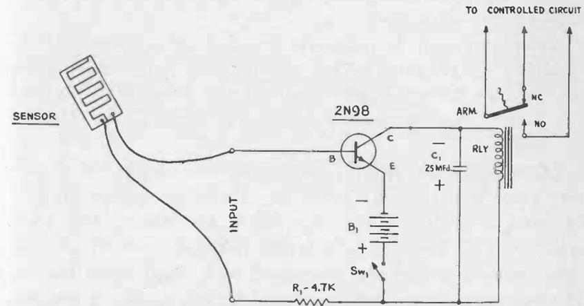
Fig. 10-4.—"Rain Alarm" circuit.
