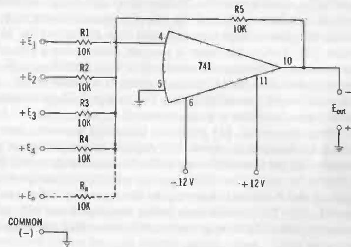
Fig. 3-21. Analog adder.
