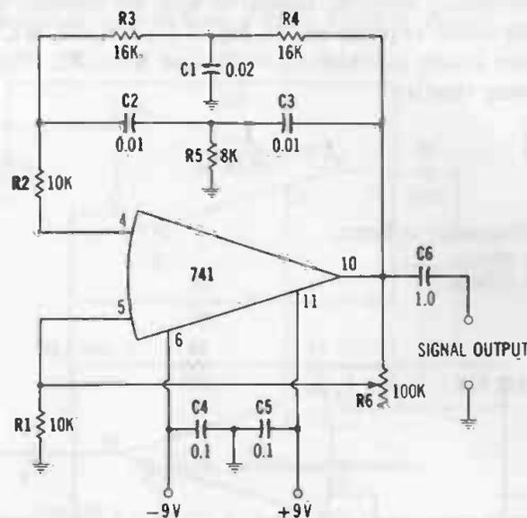
Fig. 3-10. Twin-T audio oscillator.
