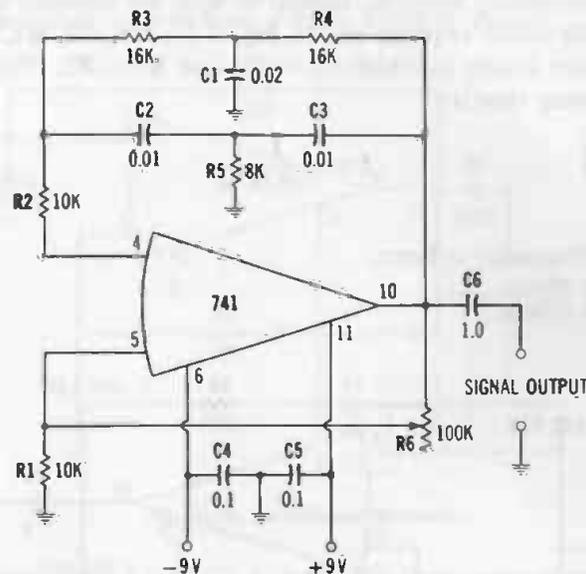
Fig. 3-10. Twin-T audio oscillator.
