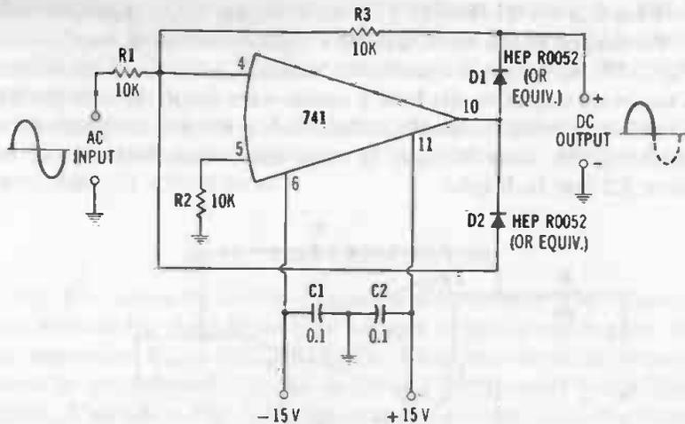
Fig. 3-20. Precision rectifier.
