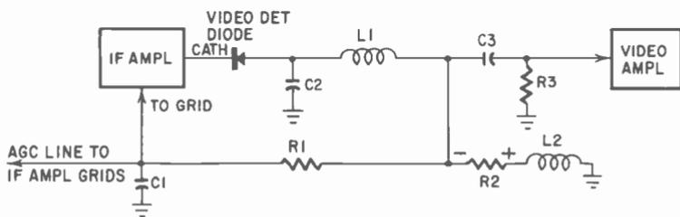
Fig. 704. Basic agc circuit.
