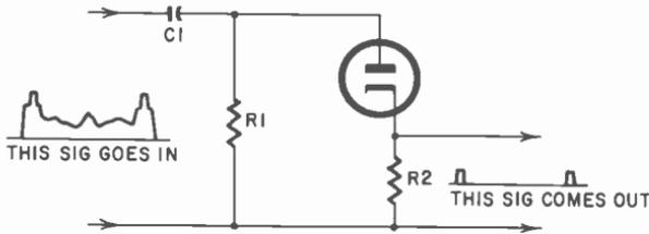
Fig. 1004. Diode sync separator circuit.
