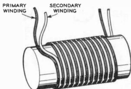
Fig. 606. *Bifilar-wound if transformer.*
