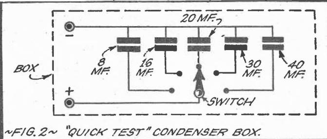
~FIG. 2~ "QUICK TEST" CONDENSER BOX.
