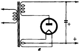
Fig. 901-a. Half-wave thermionic rectifier.
