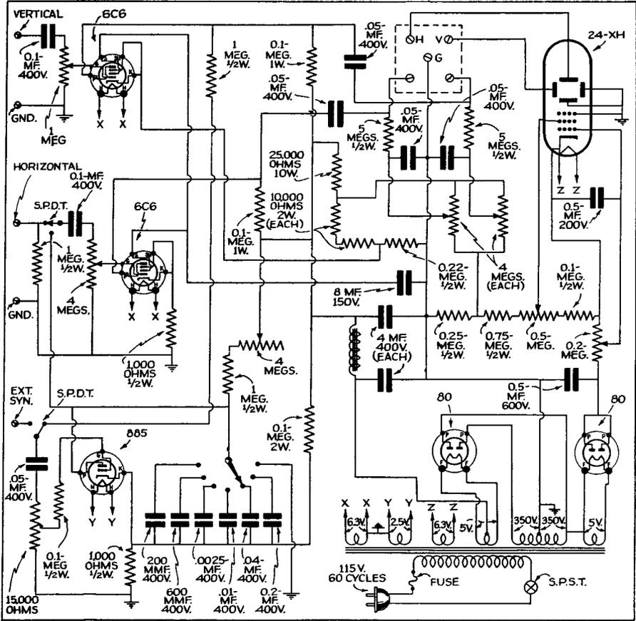
Fig. 28. Dumont 2" Oscillograph
