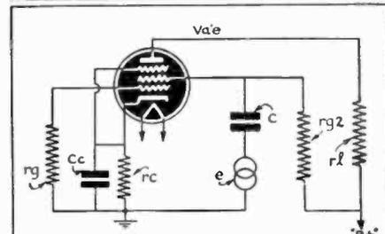
FIG. 3 ~ SCREEN-GRID USED AS A CONTROL-GRID ~
