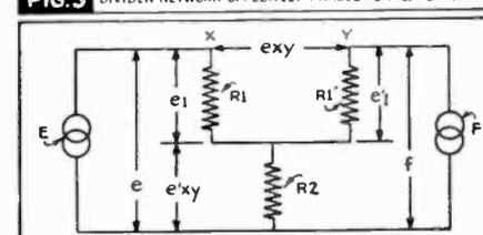
FIG. 6 ~ BASIC DYNAMIC BALANCER CIRCUIT ~
