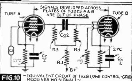
**FIG. 10** ~EQUIVALENT CIRCUIT OF FIG. 9 (ONE CONTROL-GRID RECEIVES NO SIGNAL)~
