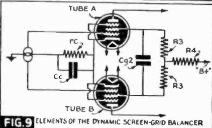
**FIG. 9** ELEMENTS OF THE DYNAMIC SCREEN-GRID BALANCER
