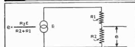
FIG. 4 ~ BASIC DIVIDER NETWORK ~
