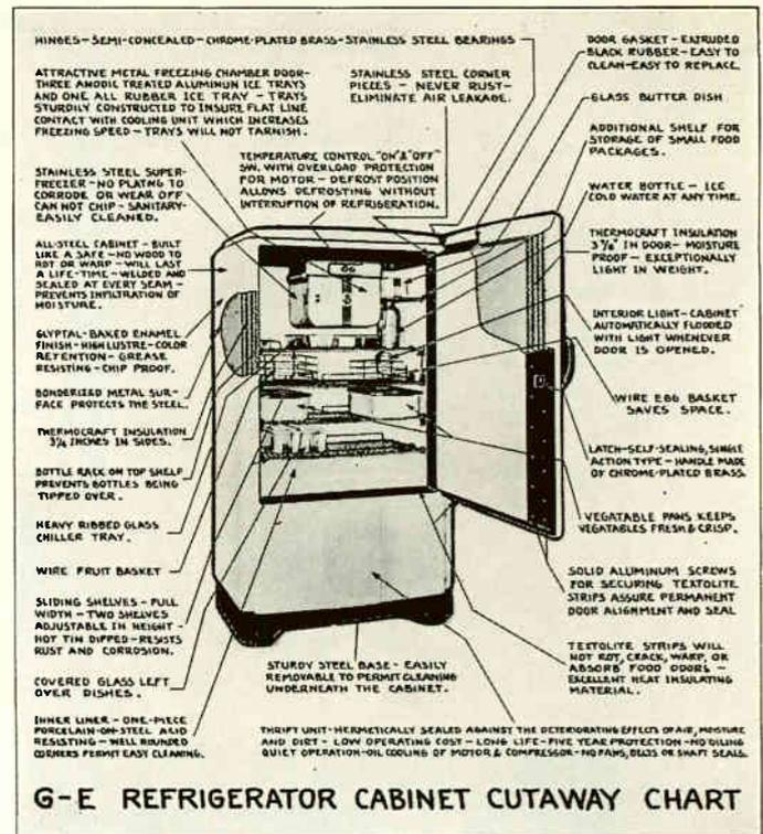
G-E REFRIGERATOR CABINET CUTAWAY CHART
