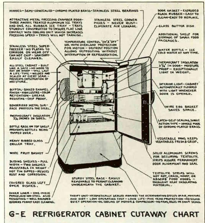
G-E REFRIGERATOR CABINET CUTAWAY CHART
