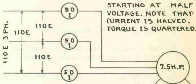
STARTING AT HALF VOLTAGE. NOTE THAT CURRENT IS HALVED. TORQUE IS QUARTERED.
