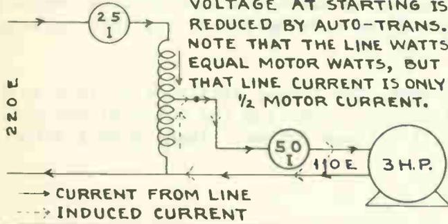
VOLTAGE AT STARTING IS REDUCED BY AUTO-TRANS. NOTE THAT THE LINE WATTS EQUAL MOTOR WATTS, BUT THAT LINE CURRENT IS ONLY  $\frac{1}{2}$  MOTOR CURRENT.
