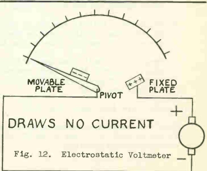
Fig. 12. Electrostatic Voltmeter
