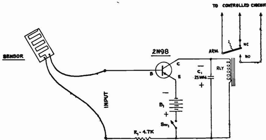
Fig. 10-4.—"Rain Alarm" circuit.
