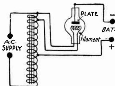
FIG. 2.—Auto-transformer for Rectifier.
