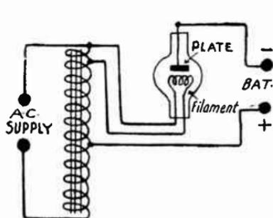
FIG. 2.—Auto-transformer for Rectifier.
