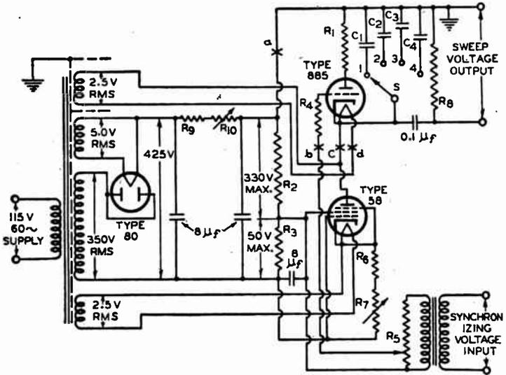
**LINEAR SWEEP-CIRCUIT OSCILLATOR DIAGRAM
