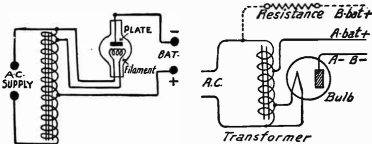
FIG. 2.—Auto-transformer for Rectifier.
