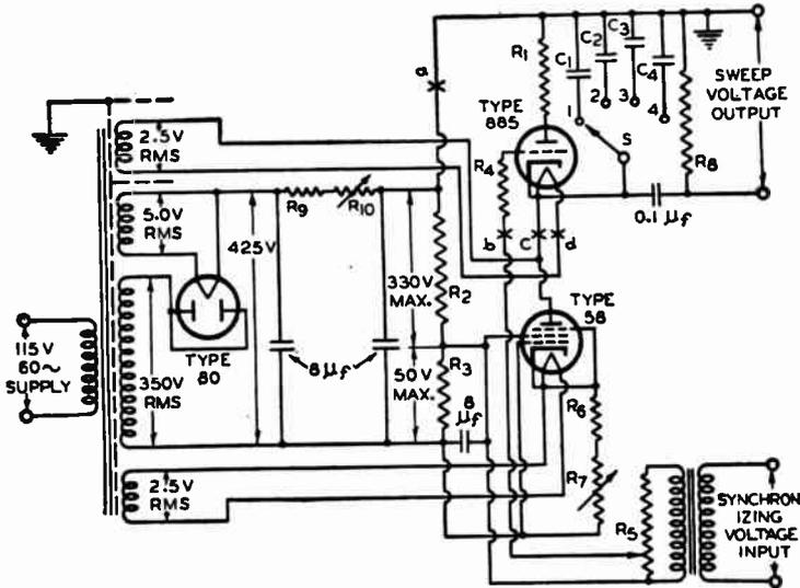
**LINEAR SWEEP-CIRCUIT OSCILLATOR DIAGRAM
